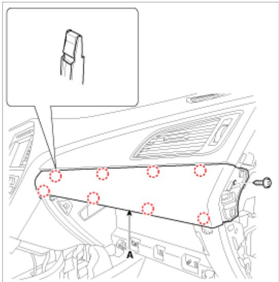
3. 拧下固定螺钉，拆卸仪表板装饰总成 [右] (A)。
