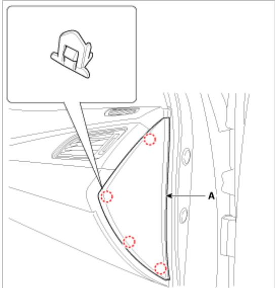
2. 拧下固定螺钉后，拆卸助手席侧仪表板装饰板 (A)。
